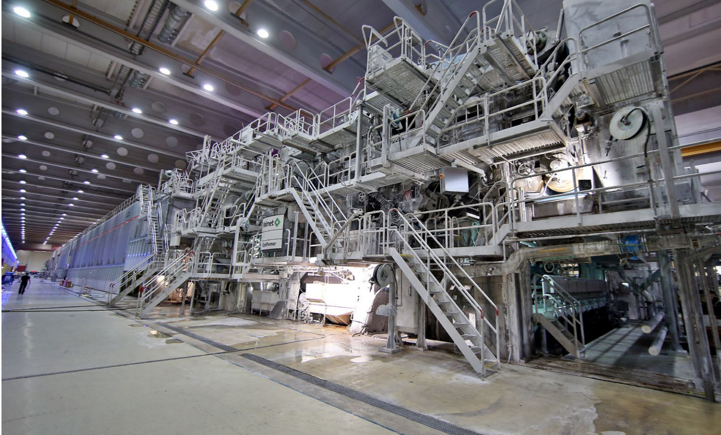
Die PM11 hat eine Bahnbreite von 8,5 Metern und ist eine der größten Papiermaschinen Europas.
